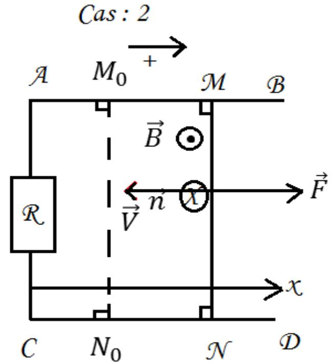
Le courant dans le circuit circule d'une façon à produire une force électromagnétique  $\vec{F}$  ( appelée force de Laplace ) de sens contraire à  $\vec{V}$  . Le sens du courant induit est déterminé par la règle des trois doigts de la main droite .
