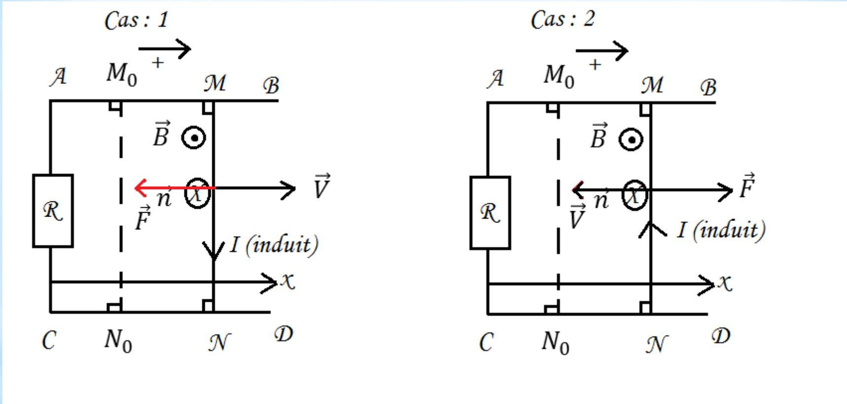
Cas : 1 , le courant induit circule de M vers N (sens positif du circuit)
